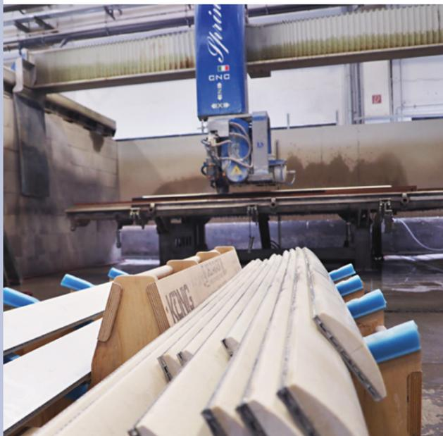
Leichtbau ist besonders auf Schiffen gewünscht, die später hohe Geschwindigkeiten erzielen sollen: KMD laminiert die von der Säge zu bearbeitenden Werkstücke – hier aus Crema-Marfil-Marmor – daher auf Alucore-Wabenplatten
