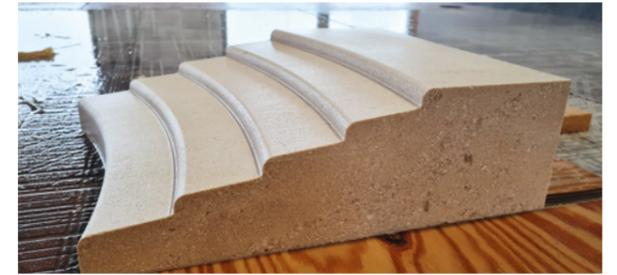
So entsteht ein massives rundes Treppenstufenprofil auf der Säge: Das Sägeprogramm sorgt zunächst fürs Abfräsen des überflüssigen Steinmaterials, bevor in zahlreichen weiteren Arbeitsschritten die weichen Stufenübergänge herausgearbeitet werden
