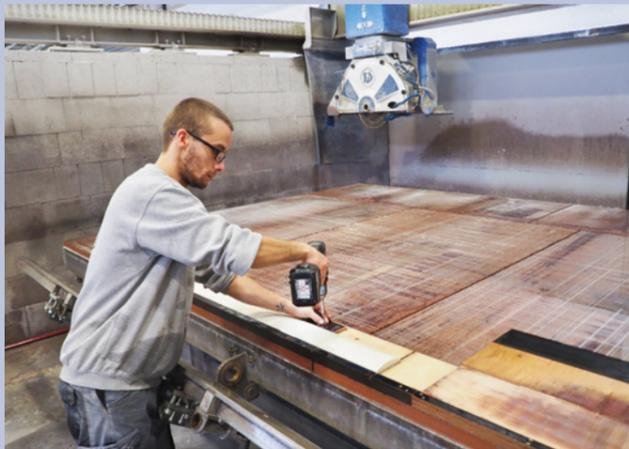
Wer kleine Werkstücke mit der Säge bearbeiten will, sollte sie gut fixieren: ein KMD-Mitarbeiter beim Festschrauben schmaler Bogenelemente
