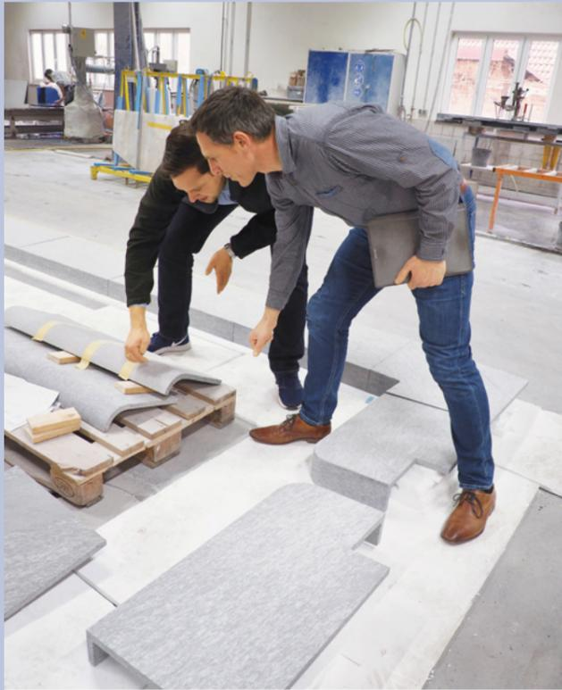
Aus dem Massivstein herausgefräst: Andreas Lohse (l.) lässt sich von KMD-Geschäftsführer Carsten Steinbrecher fertige Werkstücke für eine Badeinrichtung zeigen, die wegen der angearbeiteten Rundungen nicht mit Gehrungsverklebung möglich waren und daher aus dem Block geschnitten werden mussten
