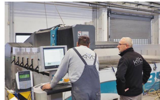
**Bei KMD im Einsatz auch als Bearbeitungszentrum:** Donatoni verkauft die flexibel einsetzbare Einkopfbrücke Zenit mit drei interpolierten Achsen und einer bis 9.000 U/min drehenden Spindel eigentlich als Kalibrier- und Poliermaschine
