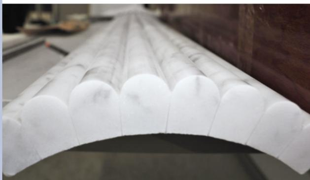
Camouflage-Säulenverkleidung: Was später wie eine massive Calacatta-Säule inklusive eines durchgehenden Aderungsverlaufs aussieht, wurde bei KMD in mühevoller Kleinarbeit aus etlichen auf der Säge und dem Kantautomaten gefertigten Einzelteilen produziert
